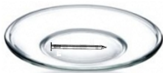
I – gwóźdź na spodku z wodnym roztworem cukru
