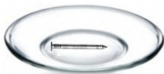
III – gwóźdź na spodku z wodnym roztworem soli
